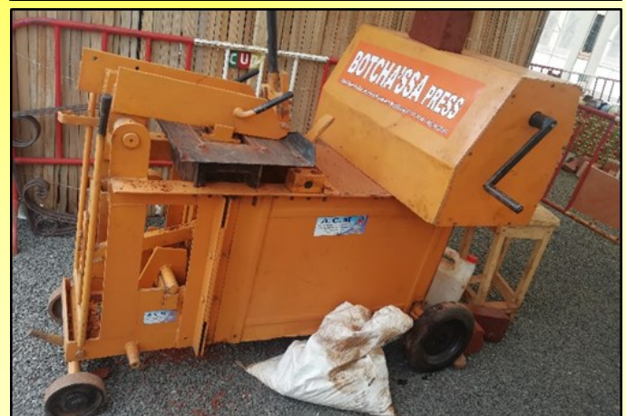
Presse de production des blocs de terre comprimée fabriquée localement à Bafoussam
